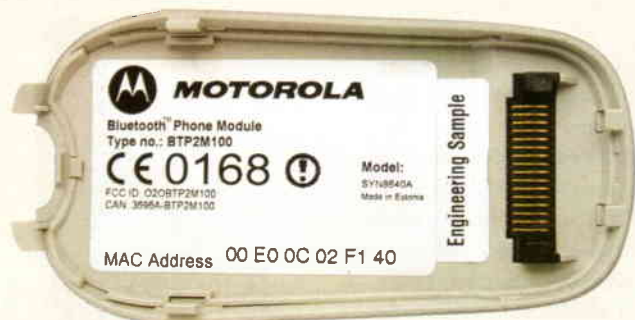
Bluetooth A chipet az akkumulátort takaró lapba integrálták.
