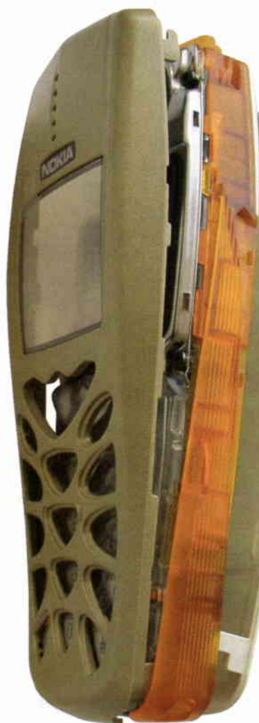
Előlap. A 3510i elő- és hátlapja elődjéhez hasonlóan házilag cserélhető.
